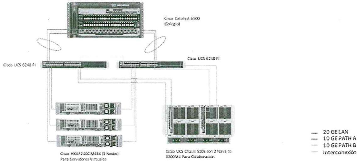
El modo de interconexión deberá ser por cables de fibra óptica de 10GE, proporcionando redundancia de la solución Hyperflex hacia los Switches nexus por dos caminos A y B para la conexión a la red del Colegio se debe adicionar 2 interfaces de 10GE por cada Switch Nexus y agruparlos, para proporcionar dos caminos de 20GE para el acceso a la infraestructura.
